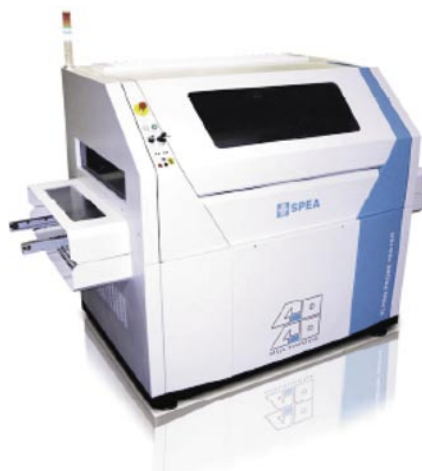
Рис. 5. Тестер с летающими пробниками типа SPEA4040: вариант для установки в линию
